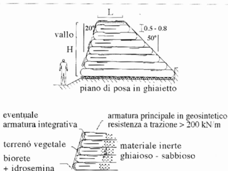
*Fig. 5.7: Sezione tipo di rilevato paramassi in terra rinforzata (Lazzari, Troisi & Arcuri, 1996)*
