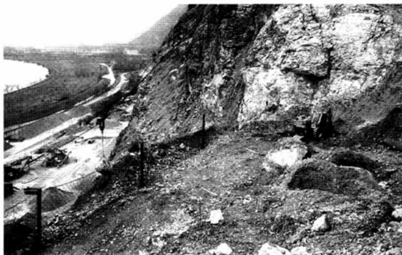
Fig. 1.4: Vista d'insieme di un campo prove durante la fase di impatto di un blocco su una barriera paramassi (Peila, Pelizza & Sassudelli, 1995)
