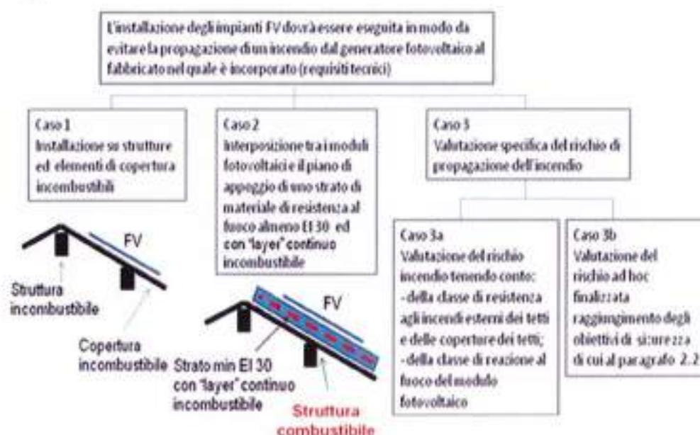
Figura 14 – Modalità di installazione di impianti BAPV
