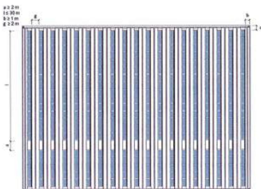
Figura 10 – Esempio di distanziamento di sottoinsiemi di pannelli su copertura a shed
