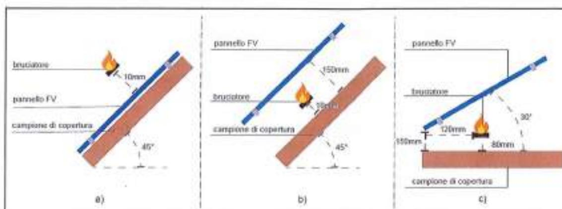
Figura 15 – Protocolli di prova secondo CEI TS 82-89
